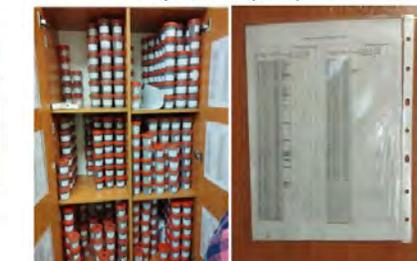
Рисунок 6.18 - Эталонные образцы для калибровки прибора.
